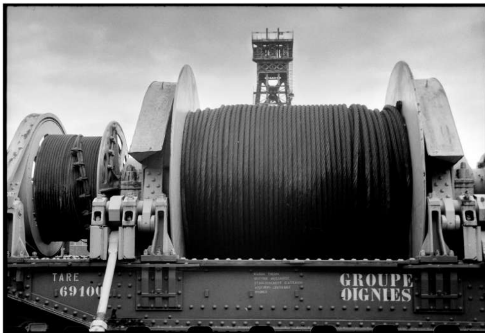
9 bis de Oignies. Le câble permettant de remonter les ascenseurs. 100T. Fabriqué aux câbleries de Lens.
